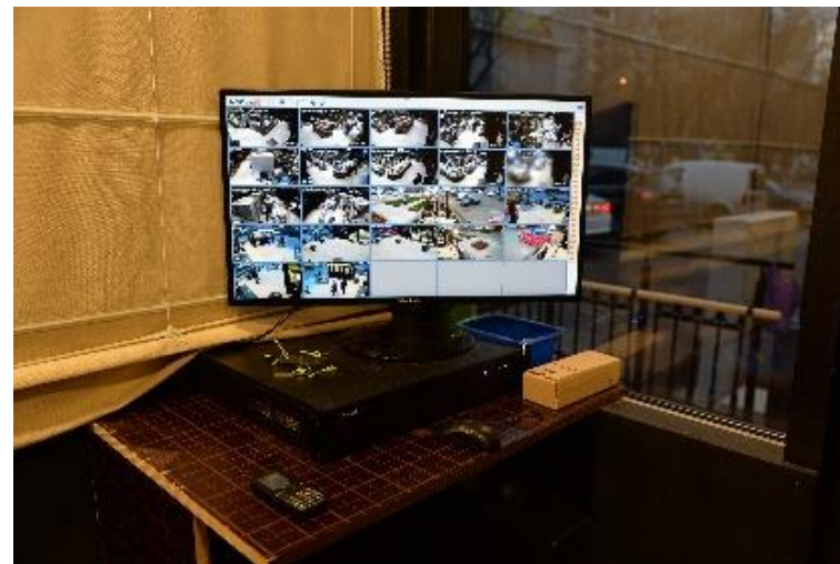
СИСТЕМА УПРАВЛЕНИЯ ВИДЕОНАБЛЮДЕНИЕМ (МОНИТОР, ВИДЕОРЕГИСТРАТОР, СЕРВЕР, МЫШЬ)
